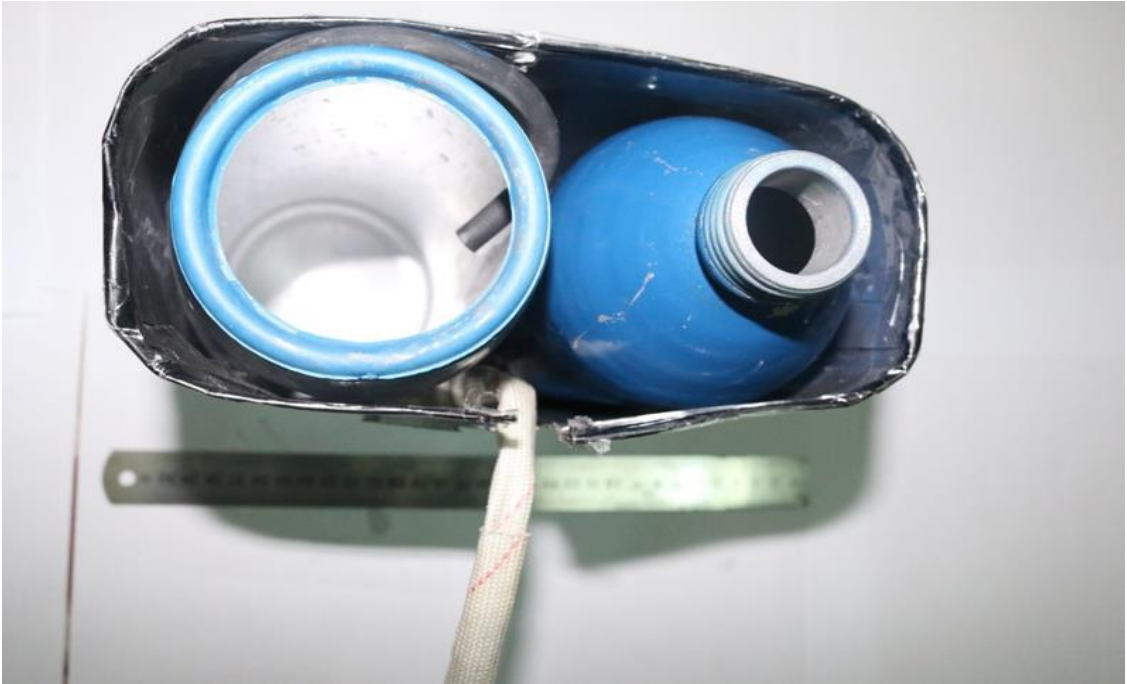
شكل رقم (15) مكان خزاني الفورمالين وبرمنكنات البوتاسيوم في داخل الحافظة مع السماح بخروج الاسلاك الكهربائية للمضخة من الشق الجانبي
