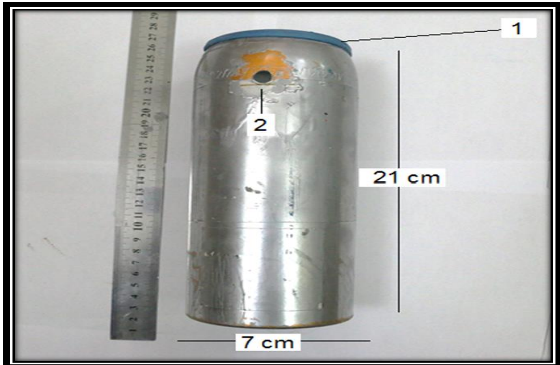
شكل رقم (4) خزان برمونات البوتاسيوم:- خزان معدني بارتفاع (21) سم وقطر (7) سم. // (1) الحلقة البلاستيكية المثبتة في فوهة الخزان // (2) ثقب علوي بقطر (10) ملم يستخدم لتثبيت أنبوب سحب الفورمالين.
