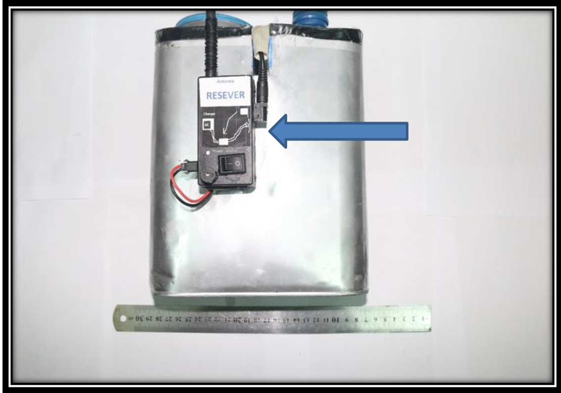
شكل رقم (16) مكان جهاز المستقبل على السطح الجانبي للحافظة وتثبيت وصلة الاسلاك في مكانها المخصص.
