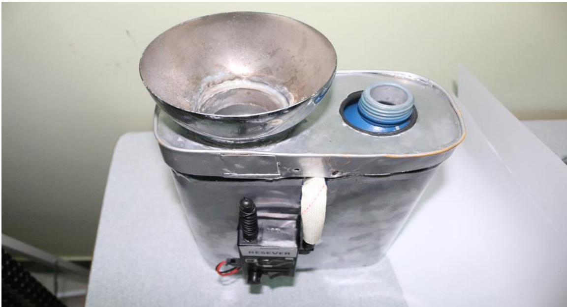
شكل رقم (17) تثبيت الغطاء العلوي في مكانه المخصص وذلك بوضع الثقب الصغير الأيمن مقابل فوهة خزان الفورمالين، وقاعدة فوهة التبخير توضع مقابل فوهة خزان البرمونات في الثقب الأيسر.
