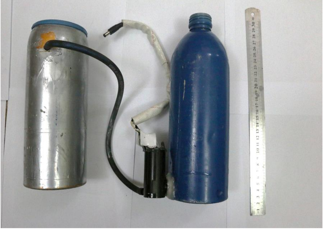
شكل رقم (14) طريقة تثبيت الطرف الاخر من أنبوب التوصيل بالثقب العلوي لخزان برمنكنات البوتاسيوم.
