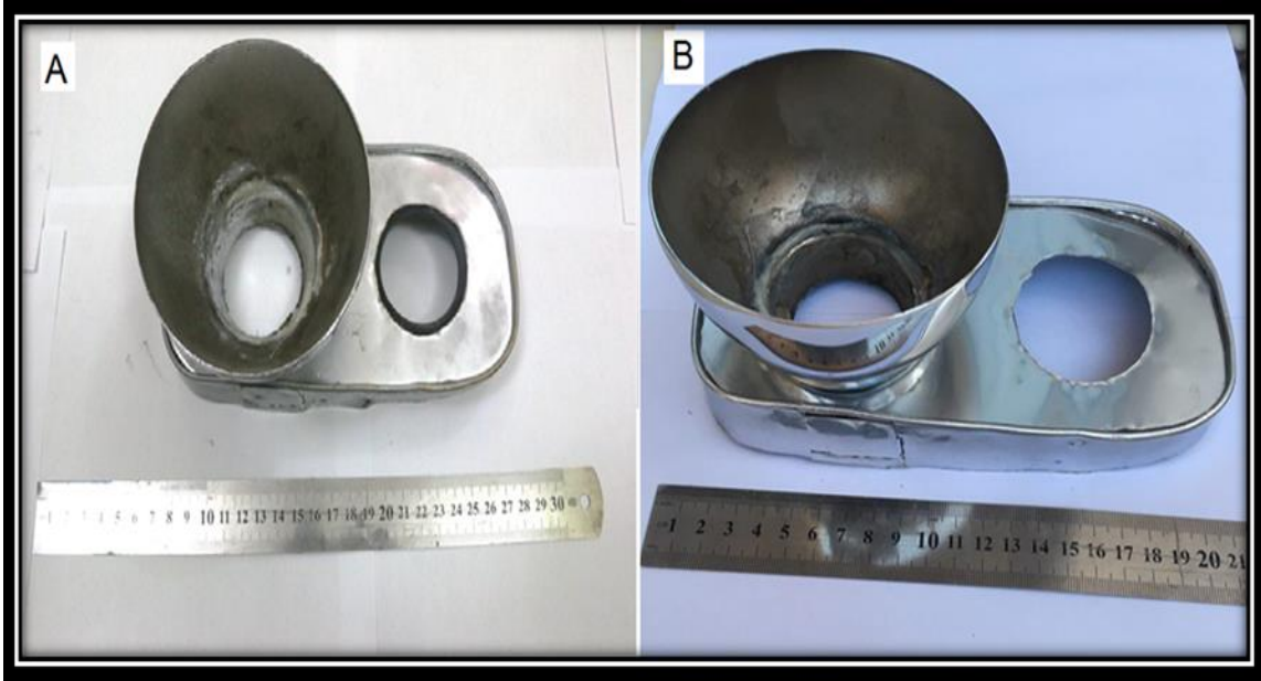
شكل رقم (10) فوهة التبخير: شكل يوضح أجزاء غطاء الحافظة الخارجية مع كيفية تثبيت فوهة التبخير.
