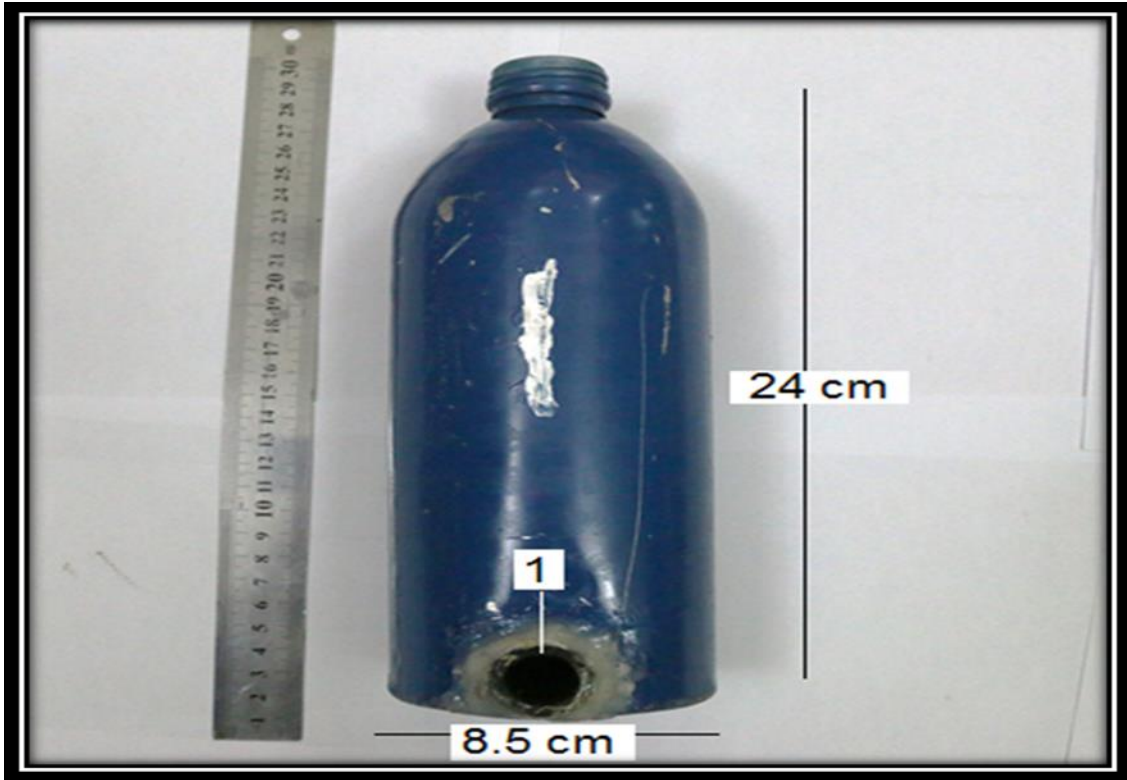
شكل رقم (3) خزان الفورمالين: الارتفاع (24) سم وقطر (8.5) سم. // (1) ثقب سفلي بقطر (20) ملم يستخدم لأنبوب سحب الفورمالين من المضخة.
